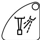
Нажать один раз кнопку **Спрей инструмента** для включения режима «вода + воздух». При этом раздаются два коротких звуковых сигнала. Кроме того, зеленый индикатор показывает, что включен режим «вода + воздух».
